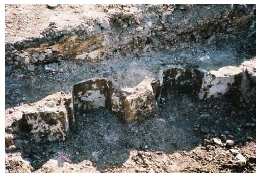
引抜き後の注入跡
